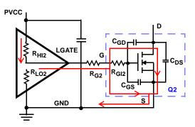
FIGURE 6. TYPICAL LOWER-GATE DRIVE TURN-ON PATH
