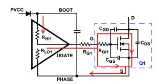
FIGURE 5. TYPICAL UPPER-GATE DRIVE TURN-ON PATH
